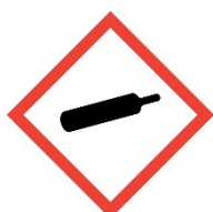
Figur 4. Varningsskylt för gasflaskor – "Gas under tryck".
