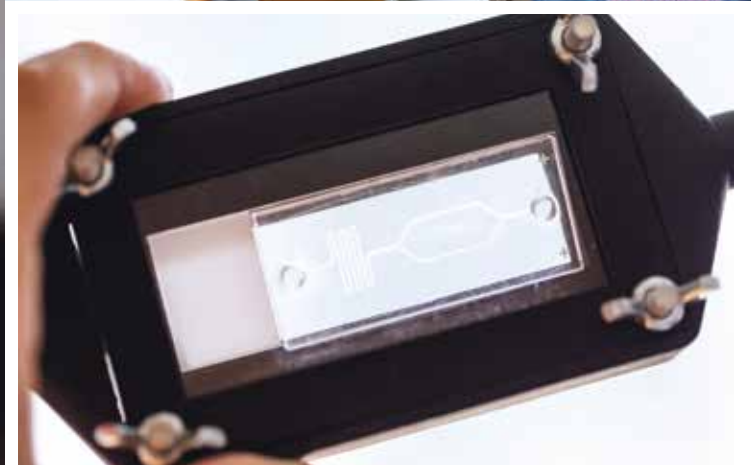
Rodrigo Hernández Vera visar en cellinkubator som han tagit fram för att på ett enkelt vis kunna avbilda cellers tillväxt. "Med den här behållaren och en mobiltelefon kan man avbilda tillväxten i realtid. Vi har blivit kontaktade av forskargrupper över hela världen som är intresserade av verktyget", berättar han.
