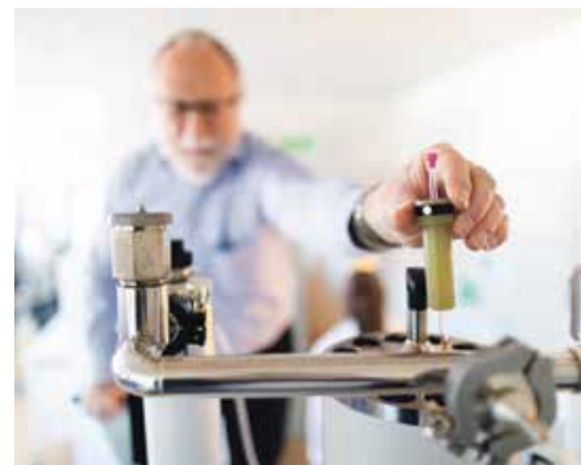
Det finns fyra NMR-spektrometrar i labbet. Instrumenten består alla av supraledande magneter som kyls ner med hjälp av flytande helium och avancerade detektorer för ett brett område av tillämpningar.
