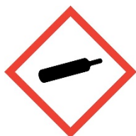
Figur 4. Varningsskylt för gasflaskor – "Gas under tryck". Gärna med tilläggs texten "Gasbehållare – för i säkerhet vid brandfara"
